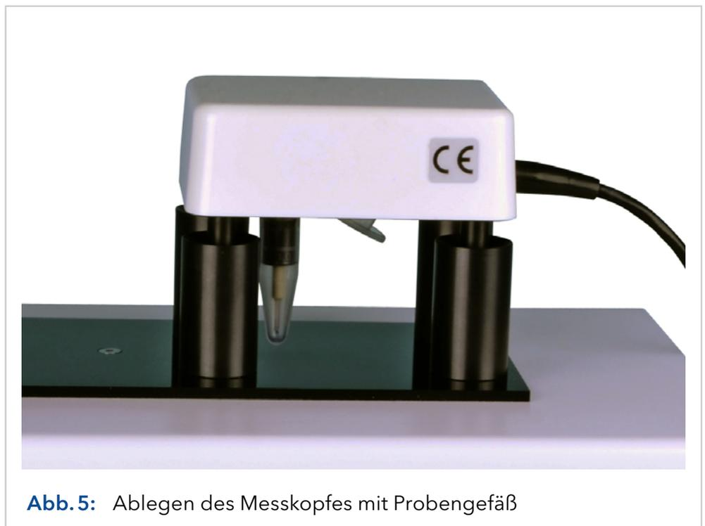
**Abb. 5:** Ablegen des Messkopfes mit Probengefäß
