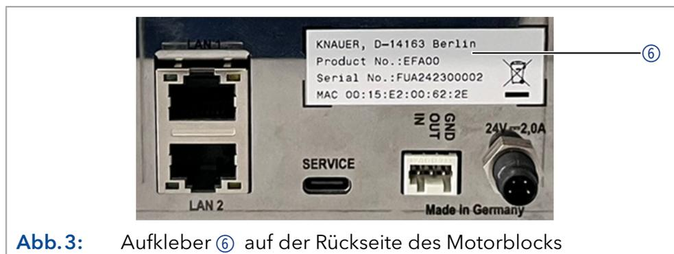
**Abb. 3:** Aufkleber ⑥ auf der Rückseite des Motorblocks
