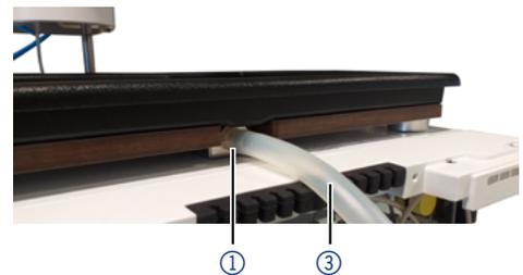
Abb. 13: Drainageschlauch mit Schlauchstutzen
